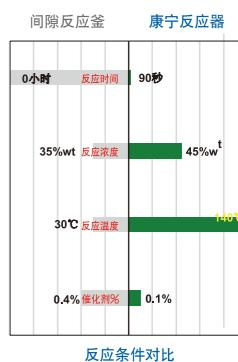
“……微反成为合理的生产敏感和不稳定中间体的方案。此技术让我们能够更好地控制热分解，同时取得理想的转化率。这些反应通常不可能用传统的方式进行。用微反应器技术大大地减少了开发这些反应的费用。另外，对普通的反应，微反应器技术可以有效地在几天内筛选出工艺条件，相反用传统的釜式反应器，一般需要几周。”
