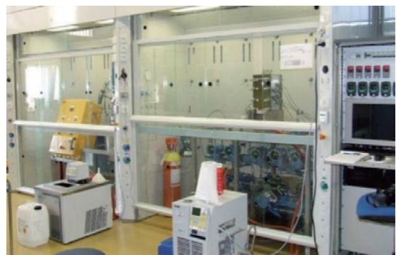
氟气极其活泼，其直接参与反应时很难控制选择性。常用的方法是先氯化，再用氢氟酸氟化。采用连续微反应器技术，为氟气直接氟化提供了便利。同时，操作也更安全，更高效。
