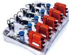
多级液液萃取(LLE)是一种重复萃取步骤以提高产品回收率的过程。在工业应用中，LLE通常采用逆流方案(CC-LLE)，以提供最小的溶剂消耗。通过多阶段提取，整个系统也可以达到较高的回收水平。
